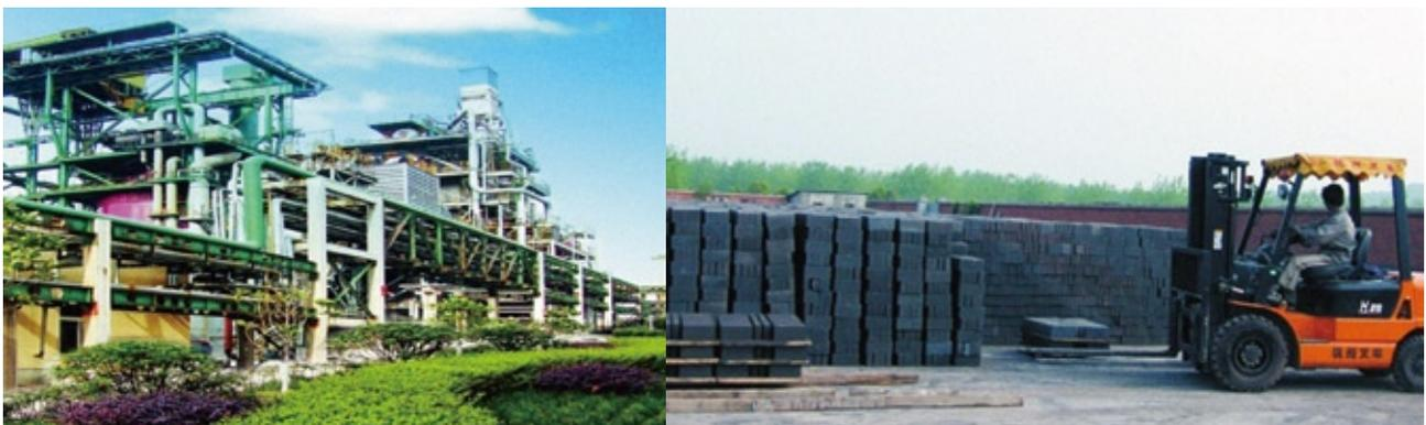
图3-34 武汉市的高炉炉渣（左）制成的青砖（右）
