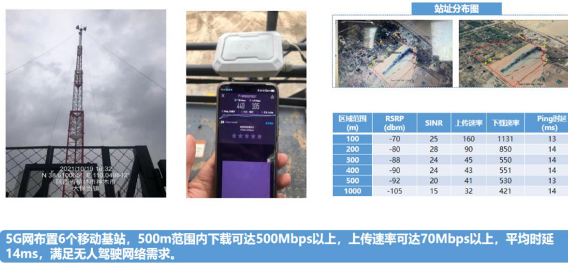
图 2 5G 通信传输速率测试
