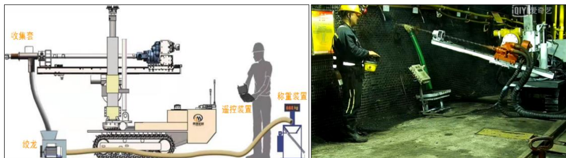
图 2 智能钻屑系统示意图与现场应用图
