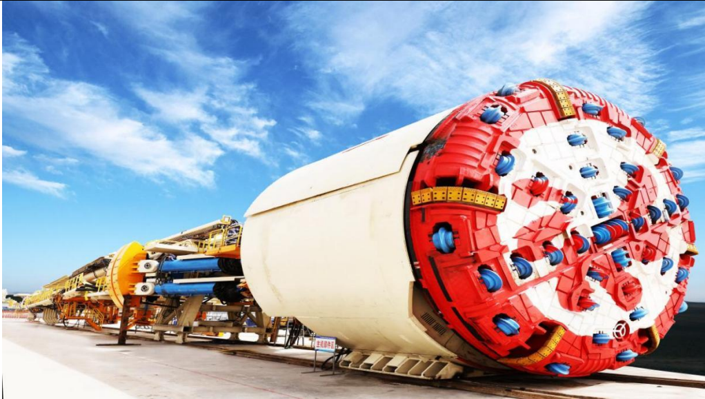
图 1 全断面掘进机主机组装完成
