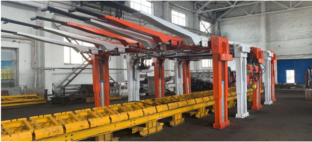
图 1 自移联排支架实景图
