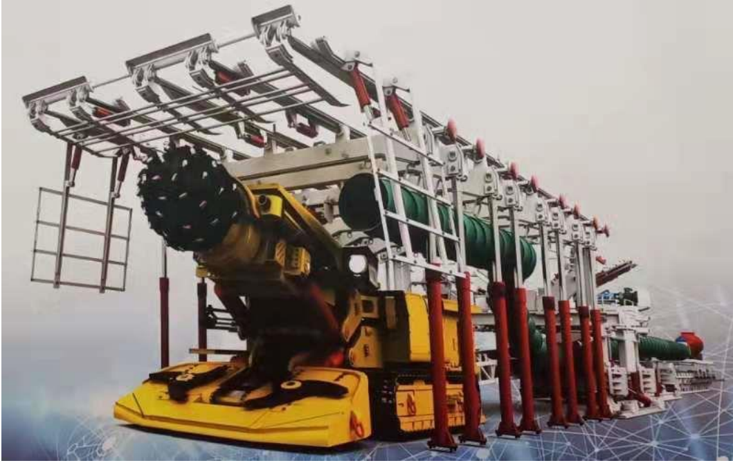
图 3 边掘边锚快速掘进成套装备
