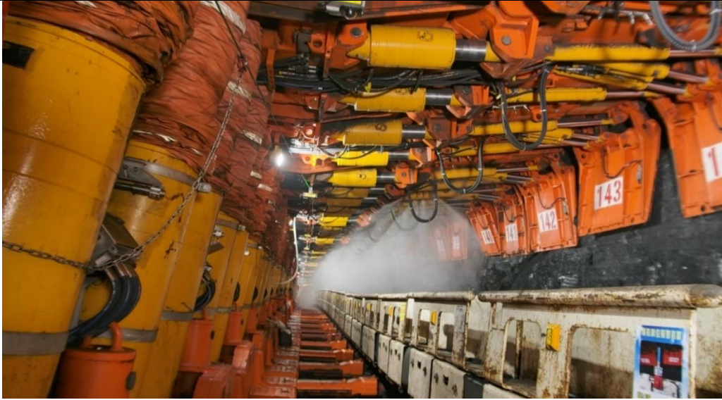
图1 工作面工作阻力 18000kN 的液压支架
