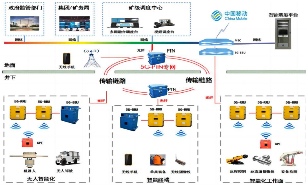
图 1 5G 调度通信系统组网架构
