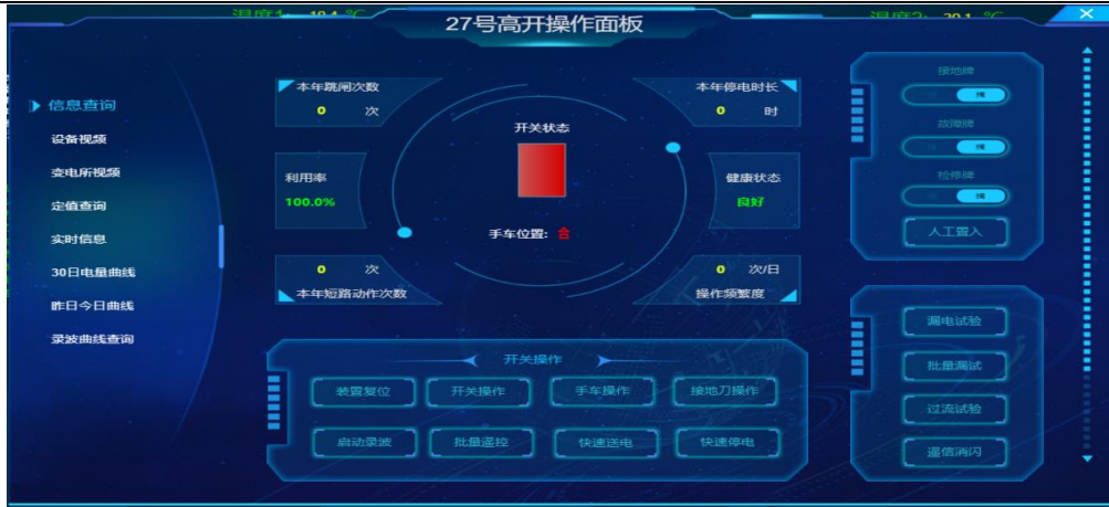
图 3 远程漏电试验、一键式复送电、带电停电区域动态着色
