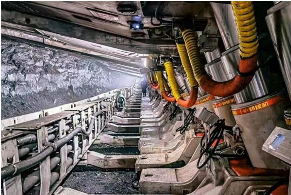
图 3 国产首套 450m 智能化综采工作面
