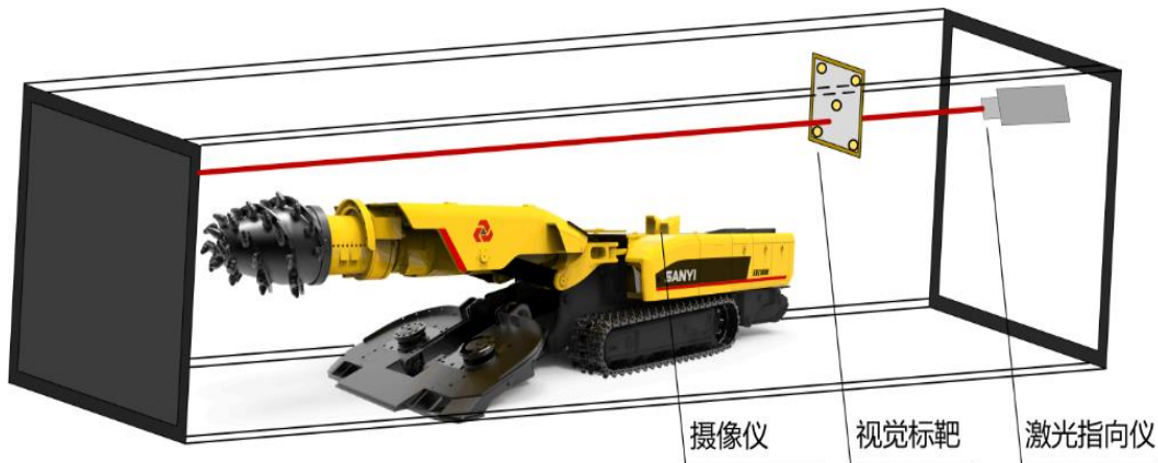
图8 掘进机位姿偏向位移的测量原理图
