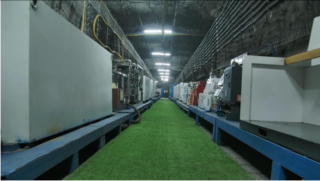
图5 “一点多面式”供电、供液
