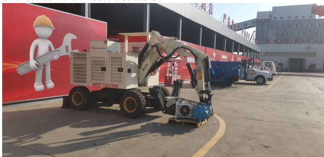
图5 煤矿用巷道修复机
