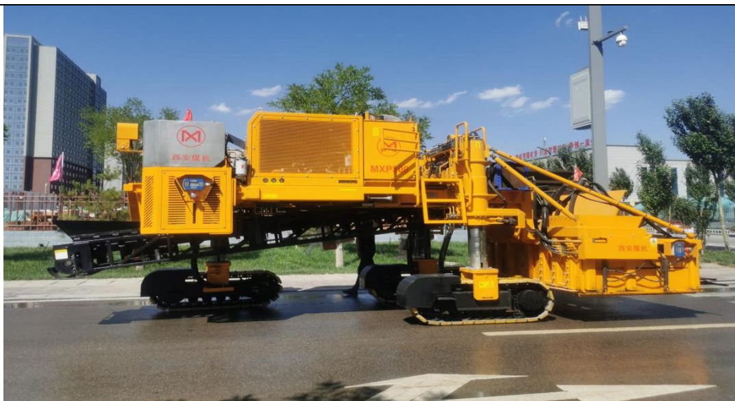
图4 混凝土摊铺机
