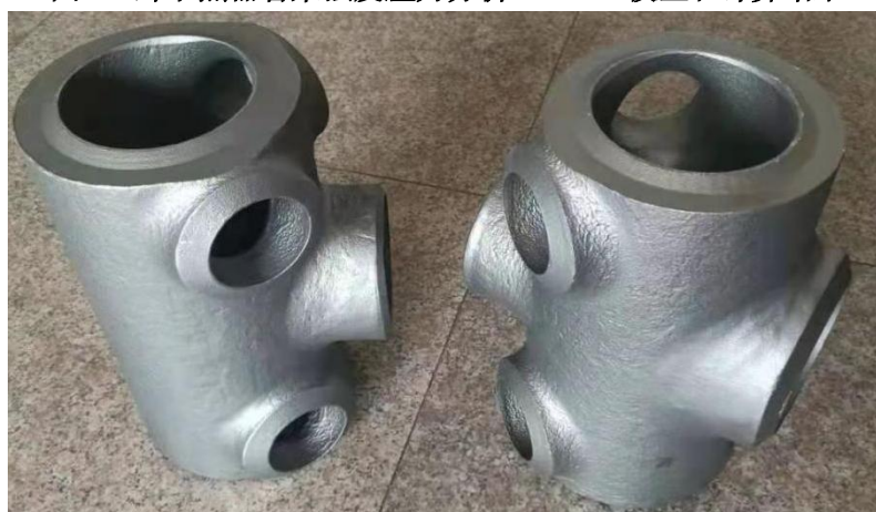
图 3 外取热器管束集合箱结构示意图
