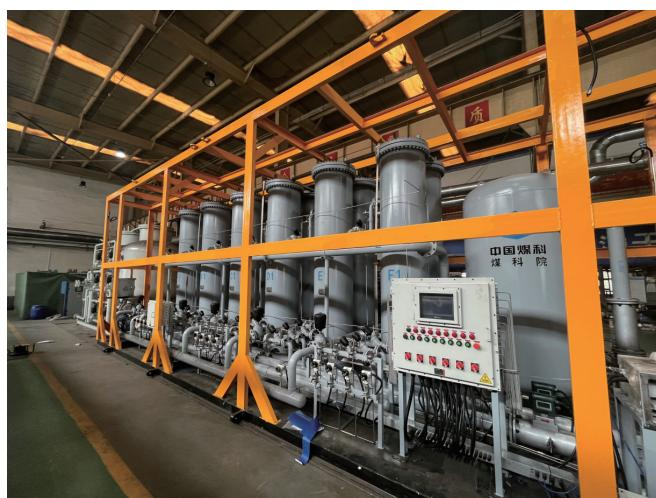
图 4 2.4 万立方米 / 天低浓度煤层气脱碳提纯撬装装置
