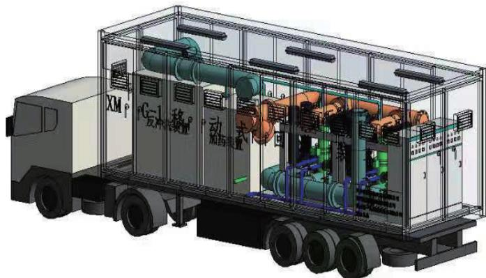
图 6 移动式地热尾水回灌站
