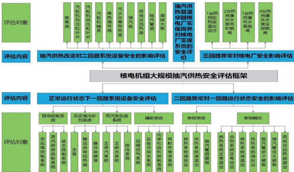
图 6 核电厂热电联供安全评估框架体系
