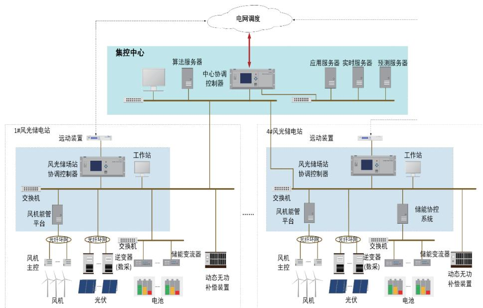
图 1 智慧集控系统结构图
