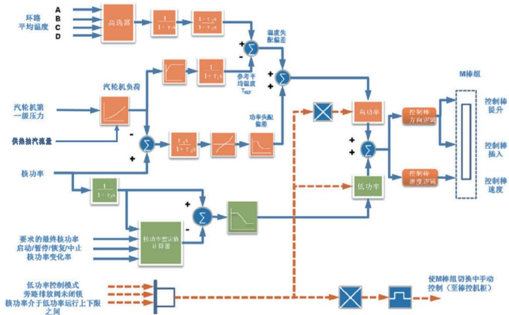
图 7 堆 - 机 - 电 - 热协调控制逻辑图
