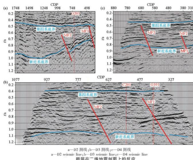
图 4 断层在二维地震剖面上的反应
