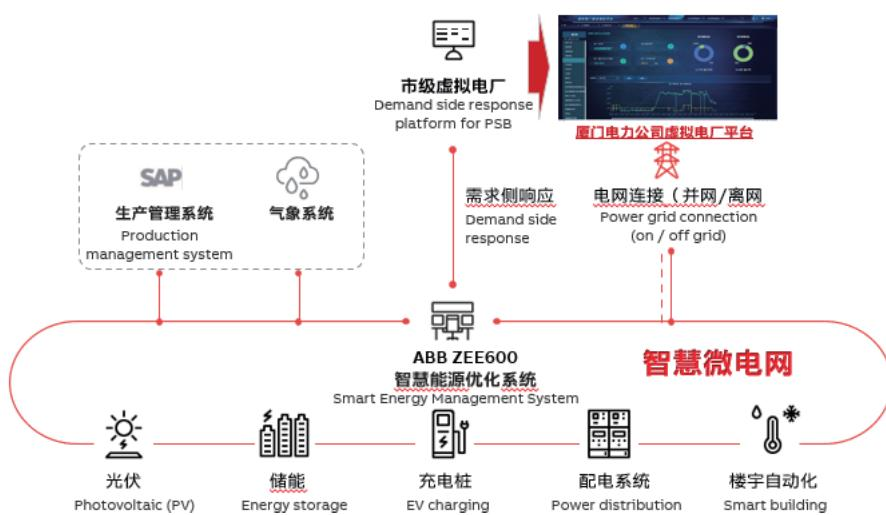
图 6 项目需求侧响应示意图
