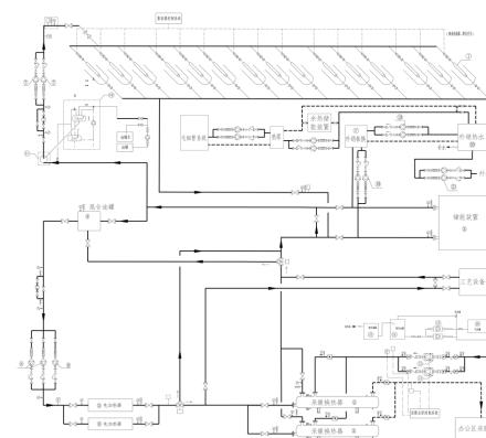
图 3 太阳能光热系统原理图
