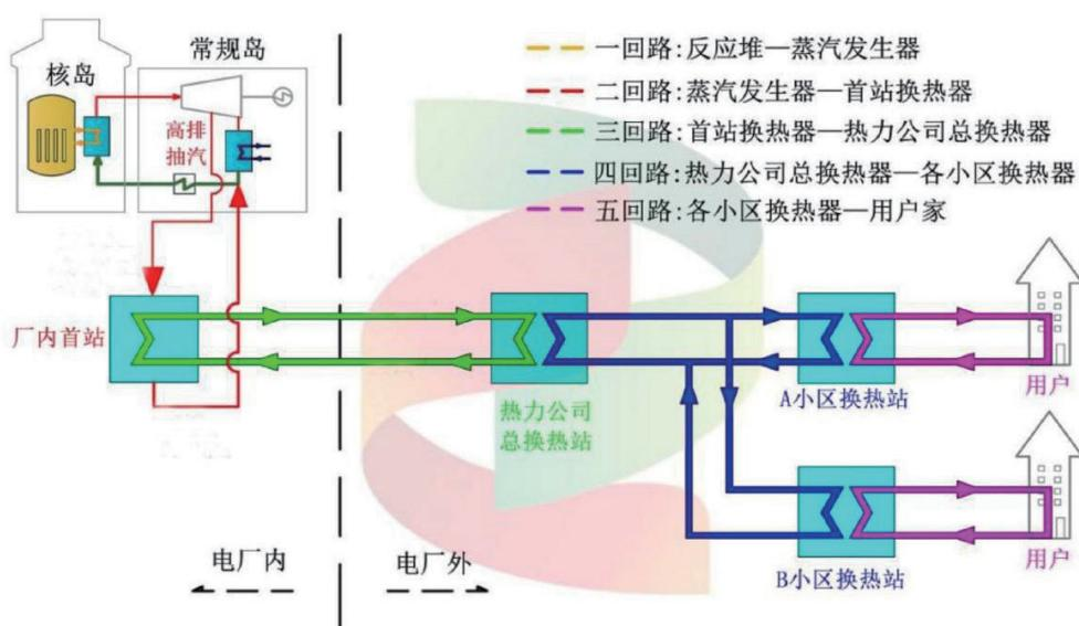
图4 核能供暖工程系统原理图
