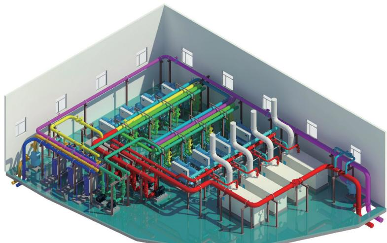
图 7 1 号能源站 BIM 模型
